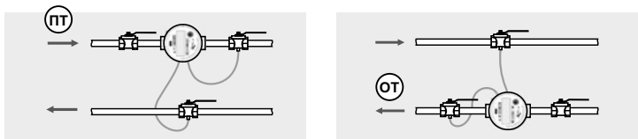
Рисунок 2 – Монтаж ИПТ в трубопровод
