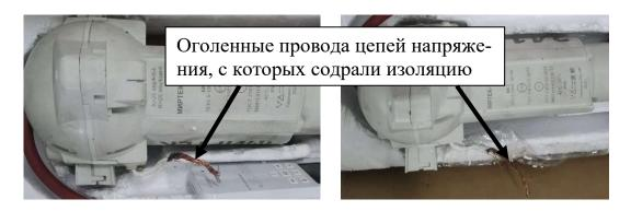
Недопустимая порча изоляции провода цепи напряжения БИ1 и БИ2
